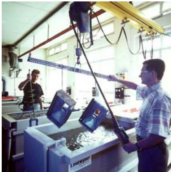
Bild 4: Tauchbad zum Feuerverzinken
